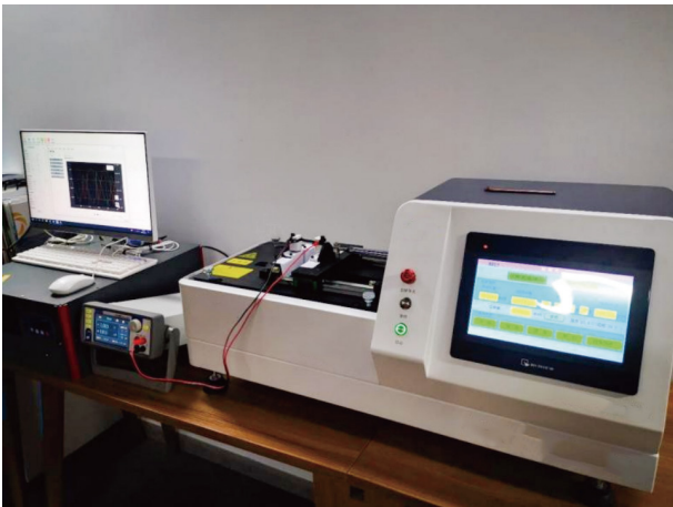
图：普赛斯S系列高精度数字源表搭配拉伸设备组成柔性电子材料测试系统
