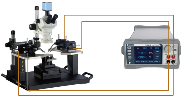
图: 四探针法测量薄膜材料电阻率
