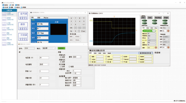
MOS管开通及关断测试曲线
